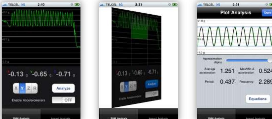
Figura 1 Demostración de selección de eje Y (izquierda), selección del segmento de interés (centro) y rotación de la interfaz tras presionar el botón de analizar (derecha).
