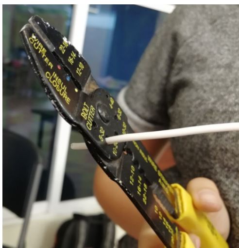
Ilustración 12 Para cortar el cable se puede usar una pinza ponchadora o de corte.
