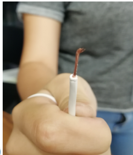
Ilustración 12 El resultado debe ser de 2cm de cable pelado por punta.
